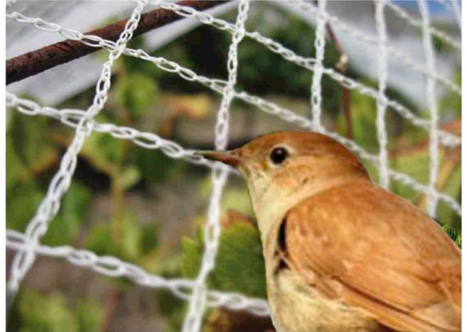
La Malla Antipájaro “Marca León”<sup>®</sup> es una red ligera de gran resistencia, ya que es tejida mediante el sistema raschel. Esta diseñada con un esquema romboidal de 25x25 mm y fabricada con polietileno de alta densidad de importación estabilizada a los rayos UV y garantizada por 5 años en condiciones normales contra la degradación solar.
